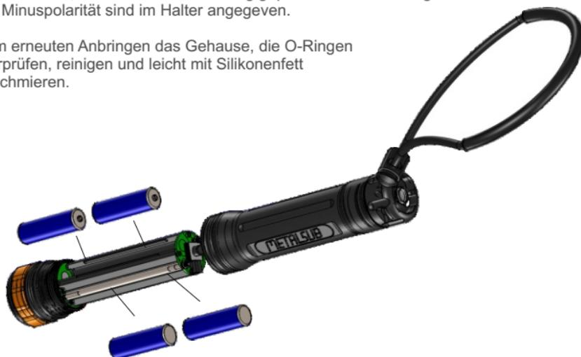
Warnung: Nur LR06- AA Alkaline Batterien verwenden von ein Hersteller und von gleiche Akku-Kapazität.
